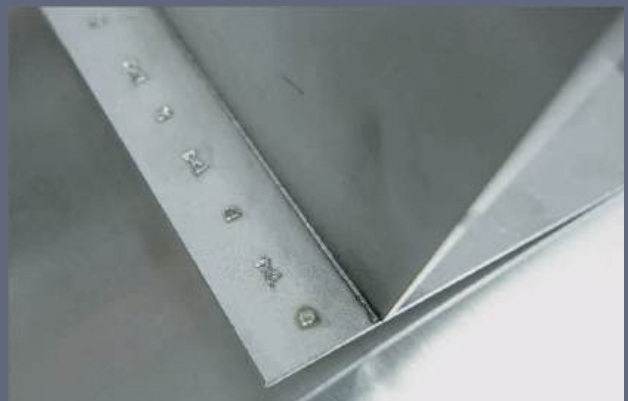
PLONŲ MEDŽIAGŲ VIRINIMAS BE PRIDETINĖS VIELOS
