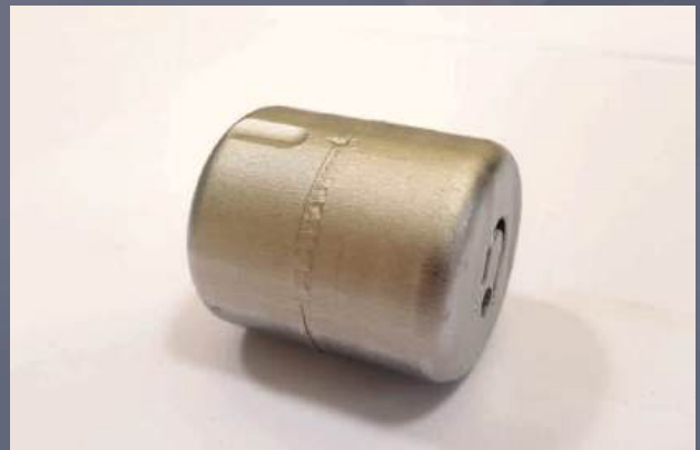
ALIUMINIO CILINDŲ SUVIRINIMAS
