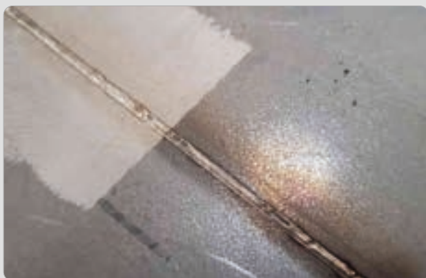
Oksidacijos valymas prieš ir po suvirinimo
