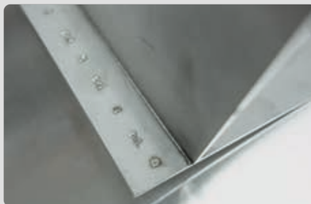
Plonų medžiagų virinimas be pridėtinės vielos
